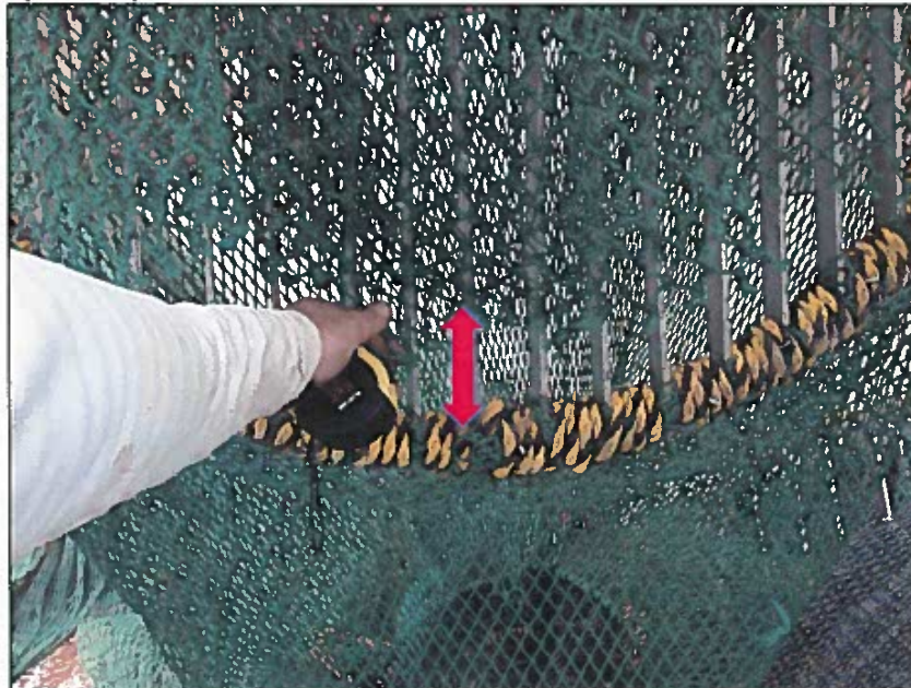
Photo 6 - Des clapets trop courts
