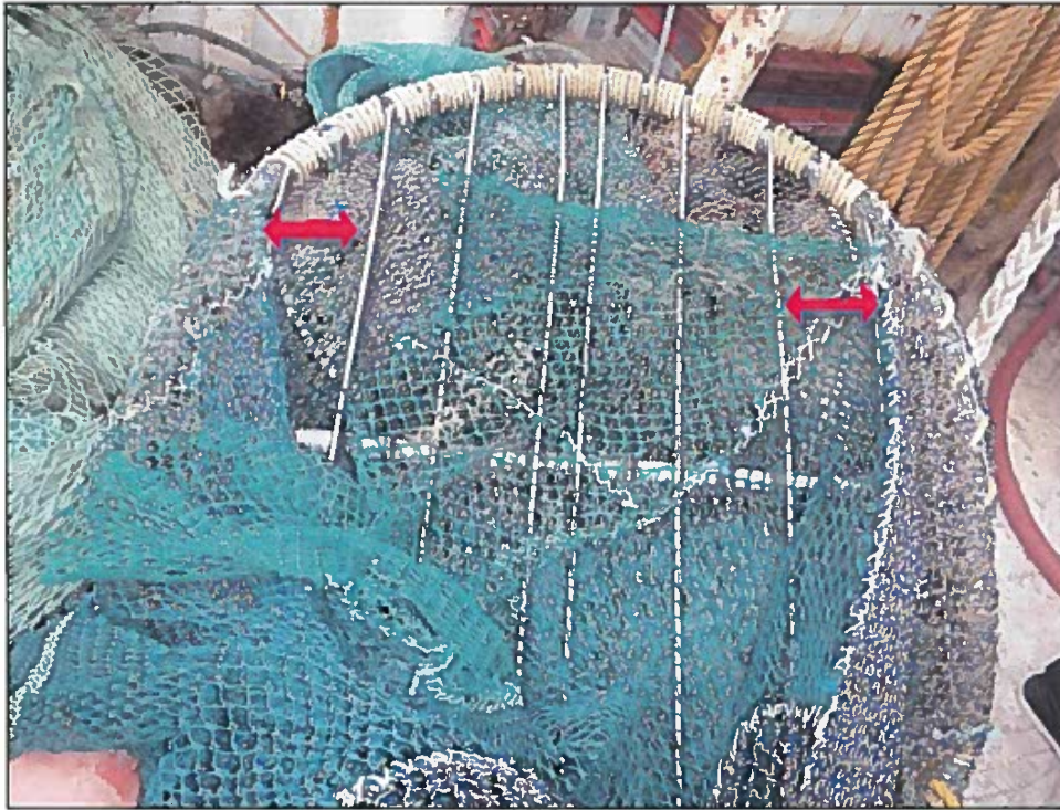
Photo 4 - TTED transformé en TED non conforme
