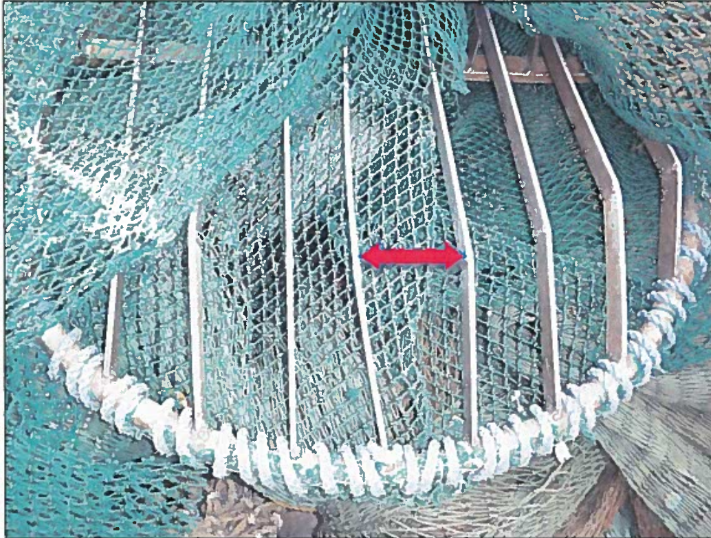
Photo 3 - TED avec des barreaux plats et des espacements non réguliers
