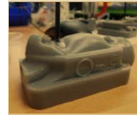
148 g / dispositif autonome (plusieurs mois) / paramètres environnementaux (T°C et P) et profils de plongées / données en quasi-temps réel
